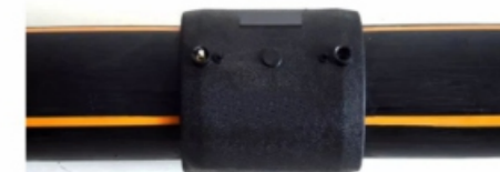
准备工作就绪后，按确认键，焊机将再次显示焊接参数，完全确认后，再按启动键开始焊接，焊接结束后会自动报警提示，焊接程序结束。
