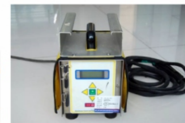
焊接时，确保焊机输入电压、时间与管件标识一致，也可直接扫描条形码进行焊接；
